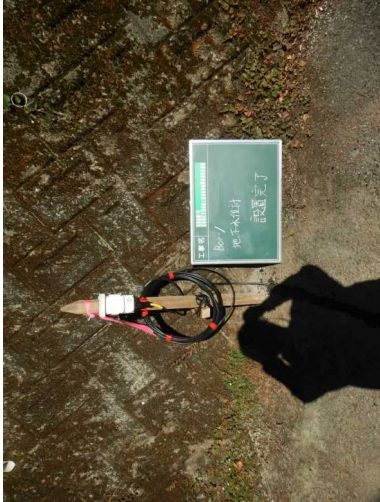
写真-Ⅱ.6.1 Bor-1の水位計設置状況 写真-Ⅱ.6.2 Bor-2の水位計設置状況 写真-Ⅱ.6.3 Bor-3の水位計設置状況
